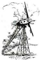
57-сүрөт. Жел тегирмен (сол жактагысы) жана кубаттуулугу 10 кВт болгон жел (шамал) менен иштөөчү электр станциясы.
